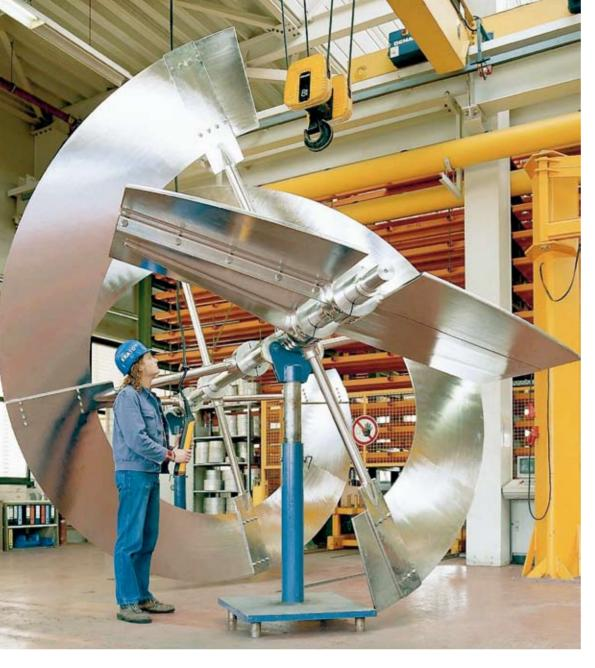
consumi energetici. In molti casi, l'agitatore può essere progettato con velocità fissa per esercizio senza dispersione o con diverse situazioni di dispersione di gas. Ciò rappresenta un vantaggio dal punto di vista dell'investimento in quanto il limite di flooding di PHASEJET consente una portata di gas considerevolmente maggiore, con un potenziale di incremento della capacità rispetto alle turbine a disco a pale piane.
