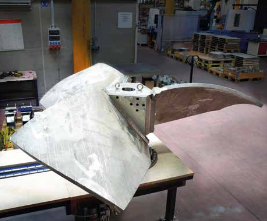
FIGURA 5 - TORUSJET EKATO PER CRISTALLIZZATORI CON DRAFT TUBE
