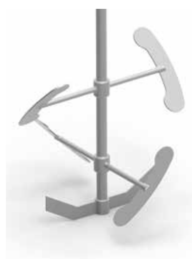
LA DISPOSIZIONE DELLE PALE PERIFERICHE NEL SISTEMA EKATO PARASEG PERMETTE L'UTILIZZO IN UN MEZZO A VISCOSITÀ MEDIO-ALTA
