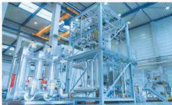
ASSEMBLAGGIO DELL'IMPIANTO MODULARE DI IDROGENAZIONE AD ALTA PRESSIONE PRESSO EKATO A SCHOPFHEIM
